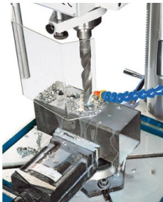
Se incluye el sistema de enfriamiento
